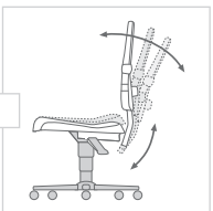
Mecanismo sincronizado con regulación de peso
